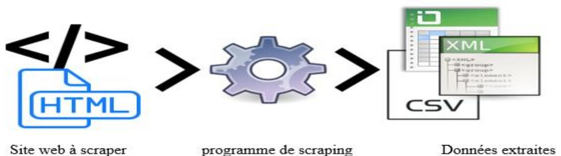
Figure 11 : Fonctionnement générique du scraping
